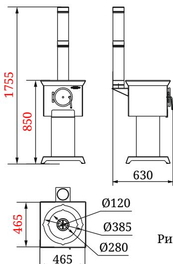
Рисунок 2. Габаритные размеры печи
