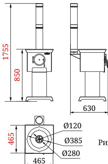
Рисунок 2. Габаритные размеры печи
